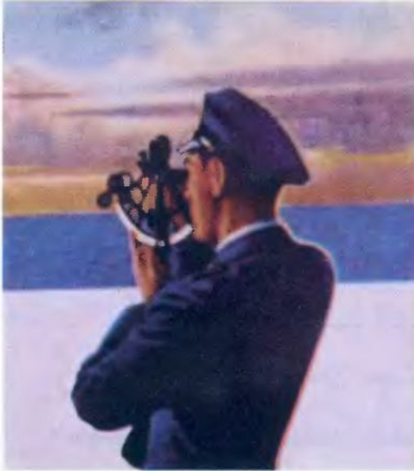
بحار يستخدم جهاز السدس .
