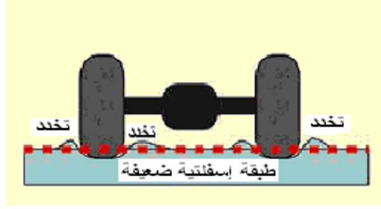
شكل (٩ - ١٠): موقع وشكل التخدد على سطح الطريق.
