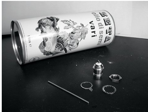
شكل 3: أجزاء هوائي العلب المعدنية.
