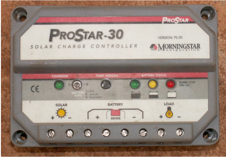
شكل 7.3: منظم لشحن الطاقة الشمسية باستطاعة 30 أمبير.
