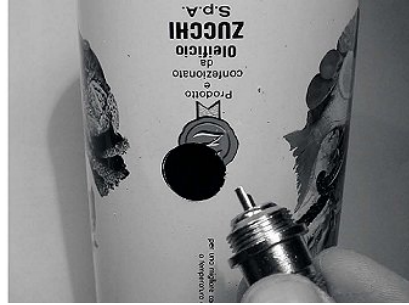
شكل 4.36: إحفر الثقب بعناية وبتدرج حتى تحصل على حجم الفتحة المطلوب.
