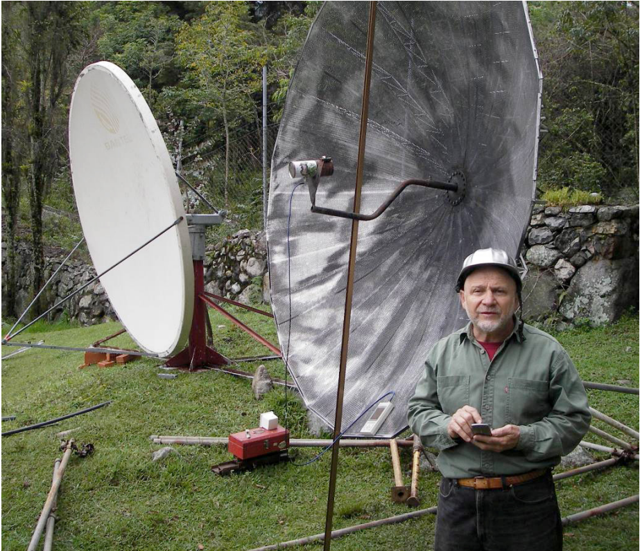
شكل 11.31: إيجاد محرق كل من الهوائيات ضمن الحزمة 2.4 غيغاهرتز.
