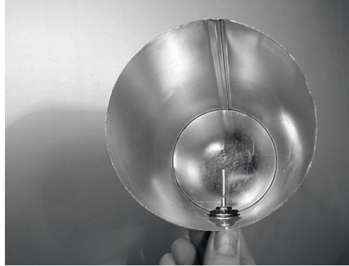
شكل 4.41: هوائي العلبة المعدنية المكتمل.
