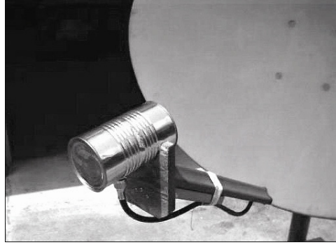
شكل 4.10: هوائي قرني مصنوع من علبه كونسرو معدنية.
