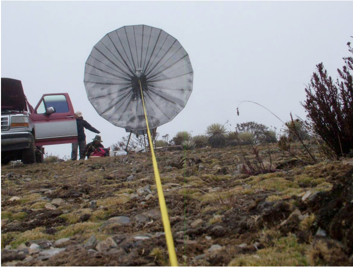
شكل 11.33: توجيه الهوائي في أغويلا.
