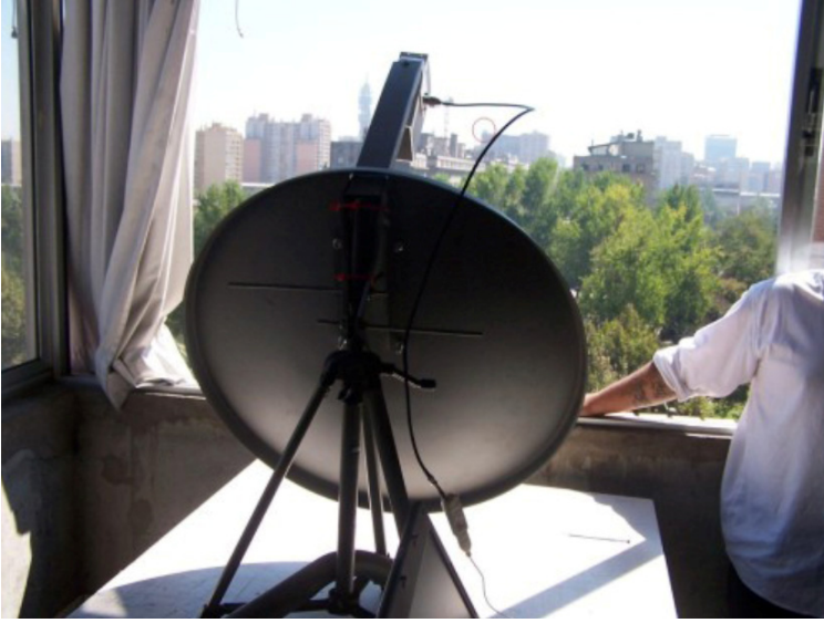
شكل 11.17: محطة لاسلكية مع هوائي قطعي Parabolic يستخدم للبث المباشر لوقائع مهرجان البرمجيات الحرة في سانتياغو FLISOL-2006 Santiago.
