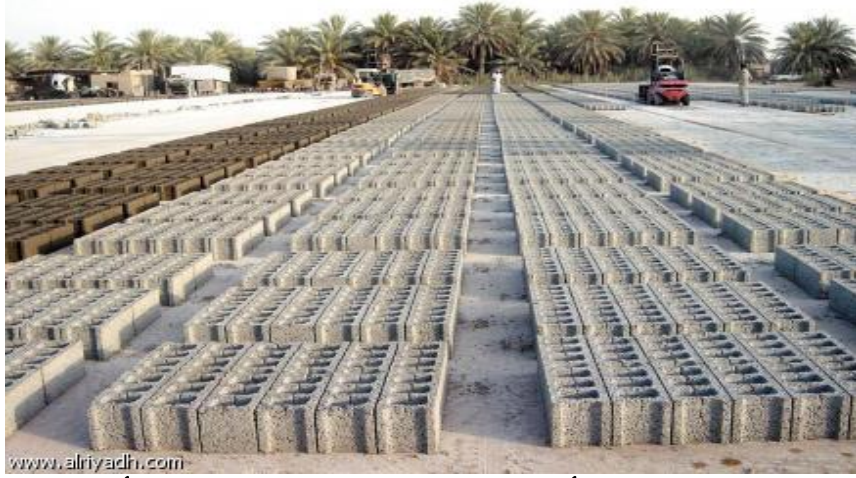
شكل 7 : يوضح أنواع مختلفة من الطوب الأسمنتي.
