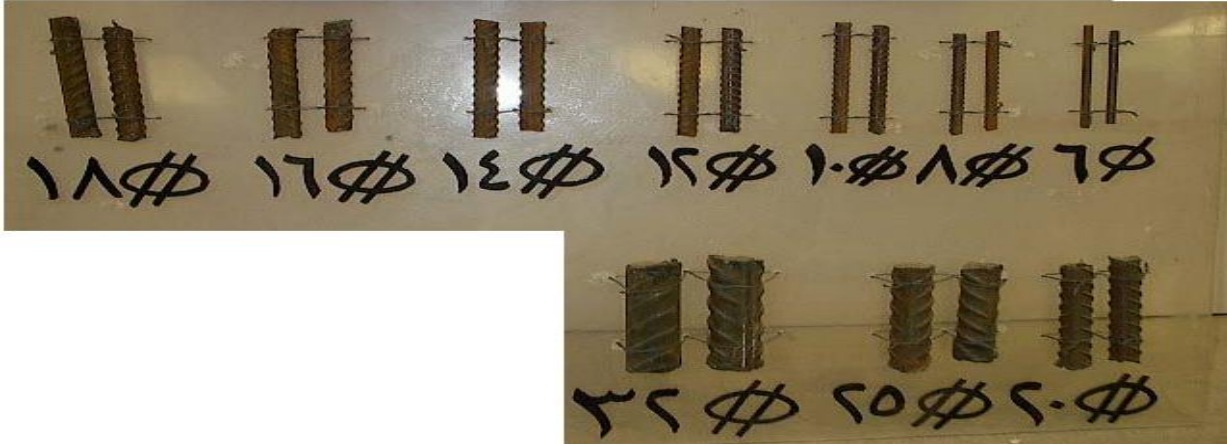
شكل 1-1 : يوضح اقطار الحديد المختلفة للصلب العالى المقاومة ( الحديد المشرشر ) .
