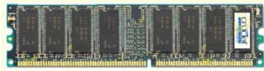
شكل لأحد أنواع شريحة ذاكرة الوصول العشوائي
