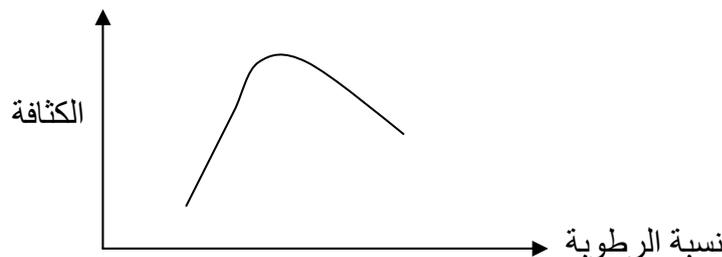
من الجدير بالذكر أن طرد الهواء من التربة المسامية يكون أسهل من باقي أنواع الترب التي تتطلب جهدا كبيرا ولذلك يفضل حذل التربة الطينية على طبقات حتى تسهل عملية طرد الهواء من الفراغات. يتم إجراء اختبارات التحقق من نسب الحذل المطلوبة موقعا باستخدام تجربة المخروط الرملي (sand cone).
