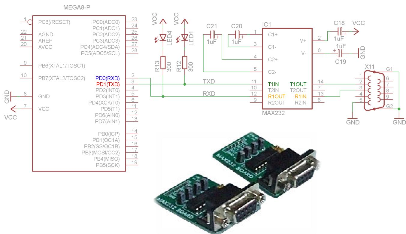
الشكل التالي يبين طريقة تحقيق دارة ملائمة TTL<>RS232 بين منفذ الحاسب التسلسلي (RS232) وبين نافذة تسلسليه (UART) لمتحكم مصغر باستخدام وصلة مفاتيح ترانزستورية.
