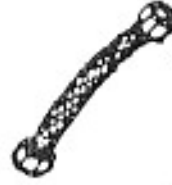
وصلة سكلاف من النسجة مانعة لتفاد المياه أو وصلة خرطوم
