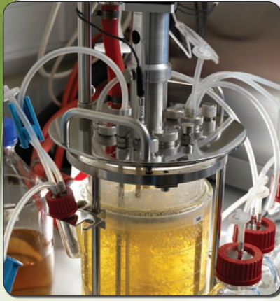
تُستخدم المفاعلات الحيوية لإنتاج الخلايا والأنسجة البشرية في المختبر.
