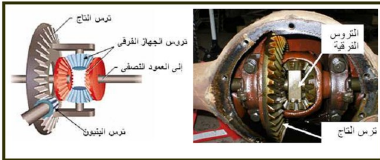
شكل (١٠): الأجزاء التي يتكون منها الجهاز العمودي والجهاز الفرقي
