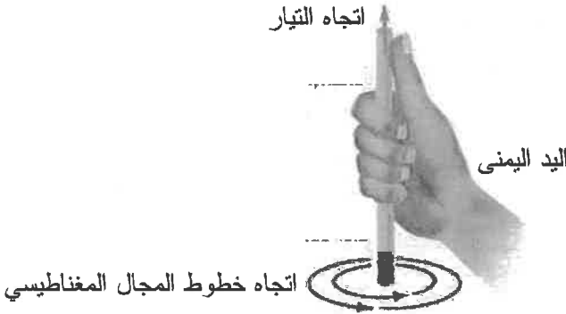
الشكل (5-16): تحديد اتجاه خطوط المجال المغناطيسي بقاعدة اليد اليمنى
