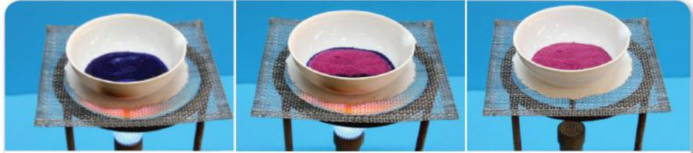
كلوريد الكوبلت (II) المائي أزرق. يمكن تسخين الملح المائي لطرد ماء التبلور. كلوريد الكوبلت (II) المائي زهري.
