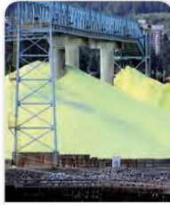
الشكل 5-9 المعبريت يتم استخراج الكبريت من مناجم البترول بوساطة عمليات كيميائية، كما يستخرج يدفع الماء الساخن إلى أماكن تجمعه تحت الأرض، فيضخ الكبريت السائل إلى السطح.
