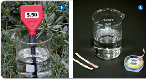
الشكل 5-18 يمكن الحصول على قيمة pH تقريبية للمحلول بوضع قطعة من ورق تباع الشمس الأحمر بالمحلول، ومقارنة لونها بمجموعة من الألوان المعيارية، كما هو مبين في الصورة a. أما مقياس الحموضة الرقمي والموضح في الصورة b فيستعمل هنا لقياس pH لمحلول حمضي؛ إذ يعطي قياساً أدق من استعمال ورق تباع الشمس.
