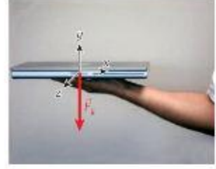
الشكل 4.4 متجه قوة الجاذبية المؤثر في كمبيوتر محمول. بالنسبة إلى النظام الإحداثي الديكارتي التقليدي باليد اليمنى.
