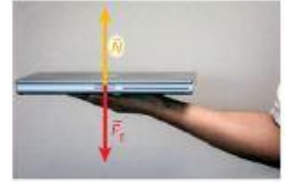
الشكل 4.6 تؤثر قوة الجاذبية إلى أسفل وتؤثر القوة العمودية إلى أعلى وهي القوة التي تبذلها اليد على الكمبيوتر المحمول.
