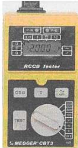
شكل (٤ - ٩) جهاز اختبار قاطع الوقاية من تيار الخلل (التسرب الأرضي)
