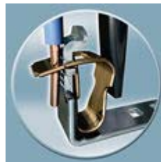
شكل (٥ - ١٢) التثبيت بشعب النهايات من اليمين بالشد بالمسمار أو الكبس
