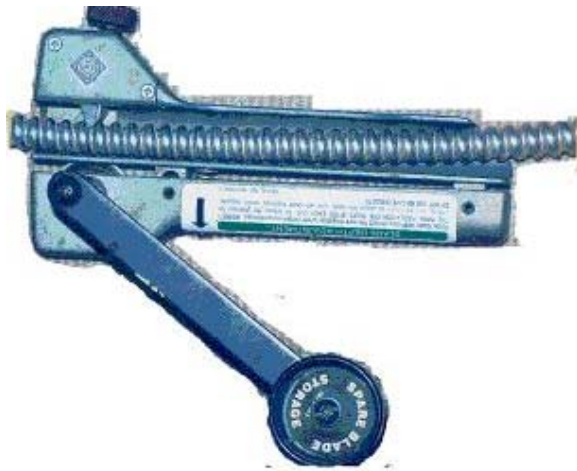
شكل (١- ١٦) ماكينة قص المواسير المعدنية المرنة
