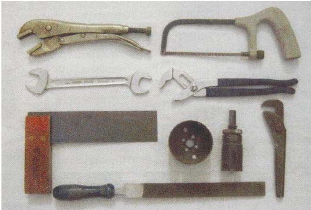
شكل (١ - ١٥) العدد اليدوية المستخدمة في التركيبات الصناعية
