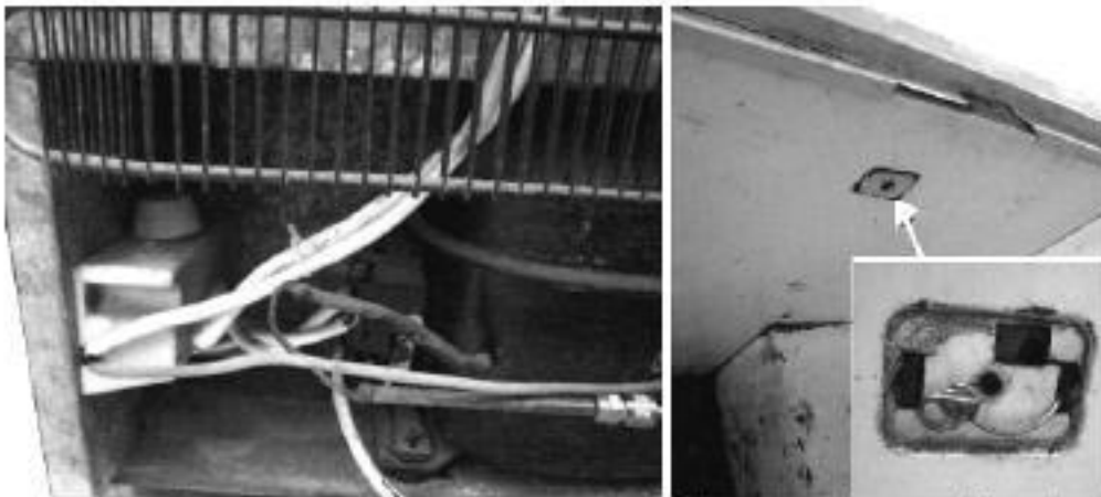
بالب الثرموستات بالداخل مكان الثرموستات بجانب الكباس
