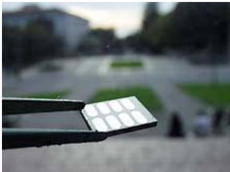
شكل ٤-٩ استقبال خلايا النانو تكنولوجي للضوء وتحويله الي كهرباء. المصدر www.tahan.com
