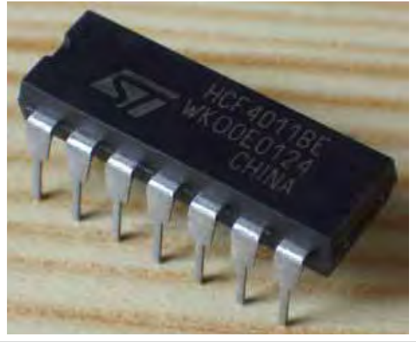
الشكل (٧): رقاقة مصنوعة بتكنولوجيا CMOS
