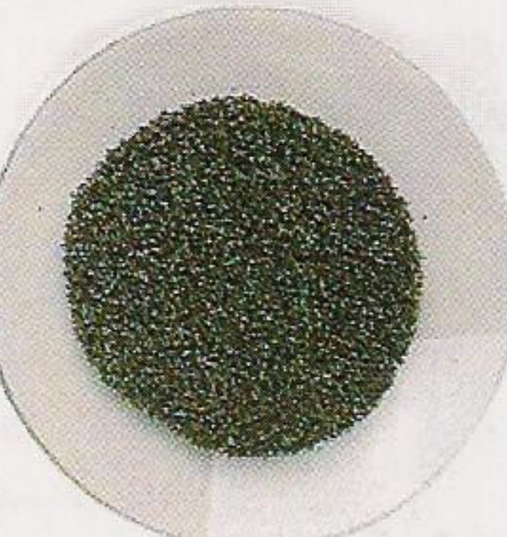
حبيبات شحن خشنة تستخدم في بداية التدوير
