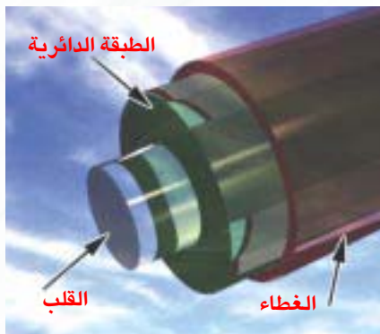
● شكل (٤)، مكونات الليفة الضوئية .
