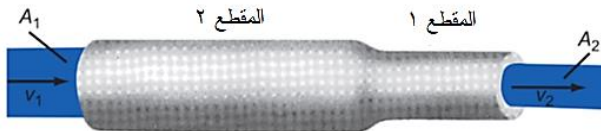
الشكل 17-2: تدفق مائع في أنبوب يتكون من جزئين بمساحات مقطع مختلفة.
