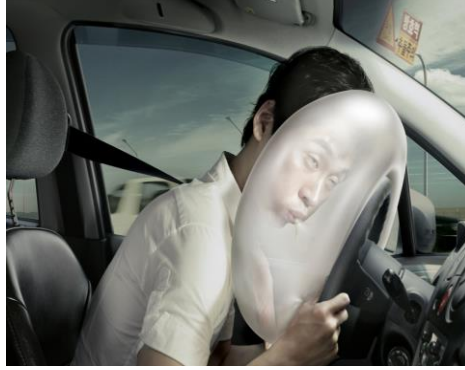
الشكل 5-6: جهاز ينتفخ بالهواء للحماية من التصادم (وسادة هوائية).
