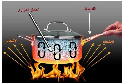
الشكل 1-3: تنتقل الحرارة من منطقة الى أخرى بالتوصيل، أو بالحمل، أو بالإشعاع.
