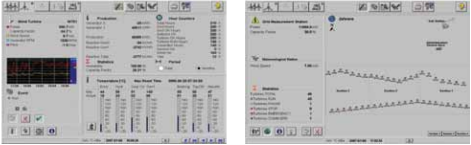
مثال لبيانات إنتاج لحظية ودرجات حرارة الأجزاء الهامة و بيانات حالة شهرية بنظام التحكم والمراقبة
