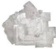
ب معدن الهاليت (الملح الصخري) له ثلاثة اتجاهات انقسام متعامدة. استنتج لماذا يمكن أن تظهر حبيبات الملح الصخري على شكل مكعبات صغيرة؟
