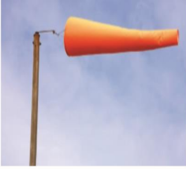
الشكل 6 يوضح قمع الرياح اتجاهها. بينما يقيس المبراج سرعتها. يشير قمع الرياح إلى الجنوب مما يعني أن الرياح قادمة من الشمال.
