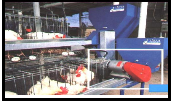
الصاجات التي يسكب فيها العلف أوتوماتيكياً
