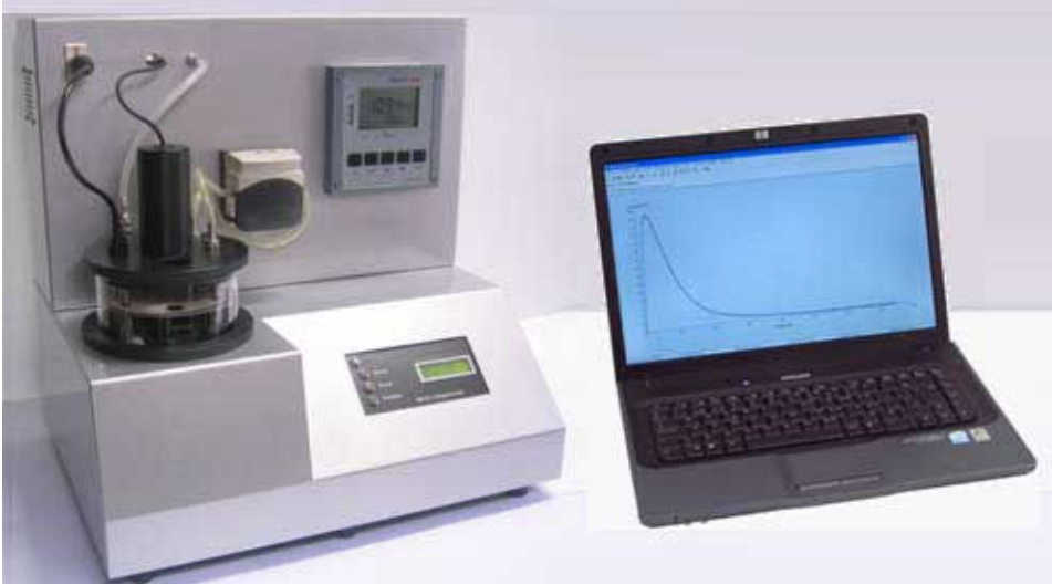
الشكل 7 - 12: جهاز قياس التنفس الإلكتروني (Respirometre Électrolytique).
