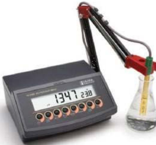
الشكل 7 - 3: صورة جهاز قياس الناقلية.
