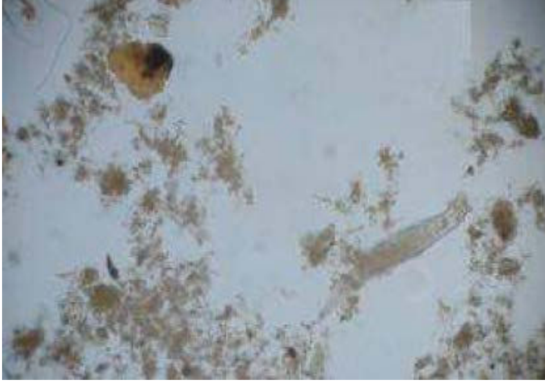
الشكل 6 - 16: صورة مجهرية للحمأة المنشطة.
