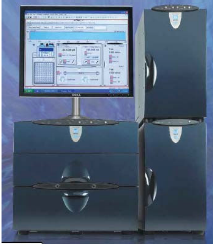
الشكل 7 - 27: جهاز كروماتوغرافيا الشاردية تصنع شركة Thermo موديل ICS-5000.
