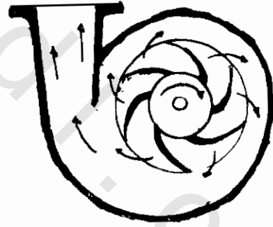
شكل (١٣١) ظلمبه الطرد المركزي الحلزونية ليس لها ريش ناشره أو للتوجيه
