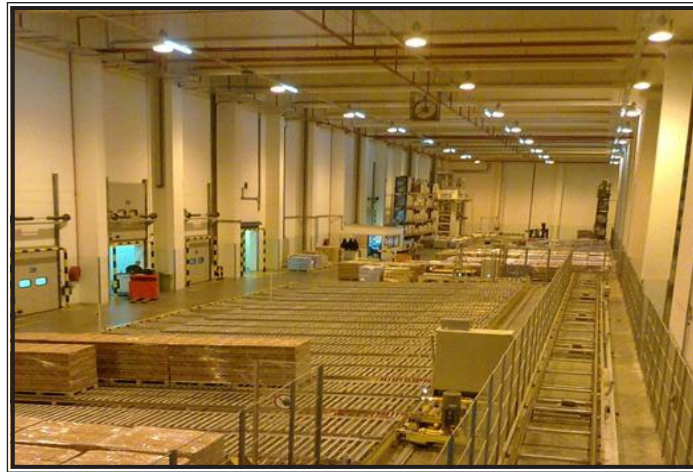
شكل (9.11): فكرة نظام الأرفف المتدفقة Flow racking system
