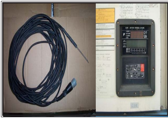
شكل (14.8): بعض أجهزة تسجيل درجة الحرارة بحاويات النقل البحري.
