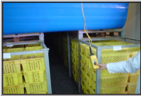
شكل (2.7ب): نفق غير محكم للتبريد السريع بالهواء المضغوط (Thompson, 2002).
