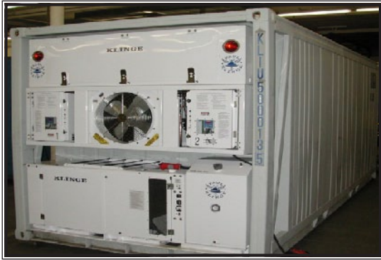
شكل (13.8): حاوية نقل بحري مبردة.
