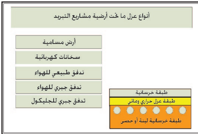
شكل (9.12): أنواع عزل ما تحت أرضية مخازن التبريد متعددة الأغراض.
