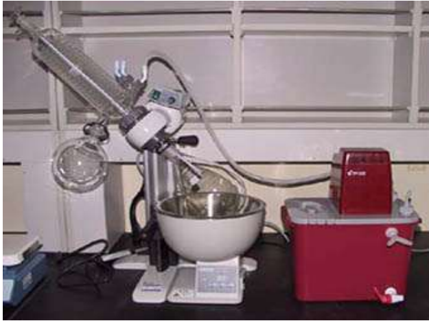
الشكل ( 91 ) جهاز التبخير الفراغي الدوار .
