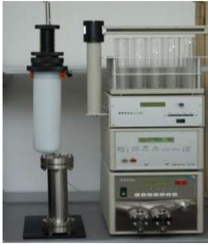
الشكل (92): عمود الاستخلاص ذو الطور الصلب
