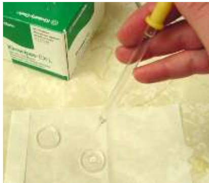
الشكل (109) :وحدة وضع العينة في جهاز طيف الأشعة تحت الحمراء
