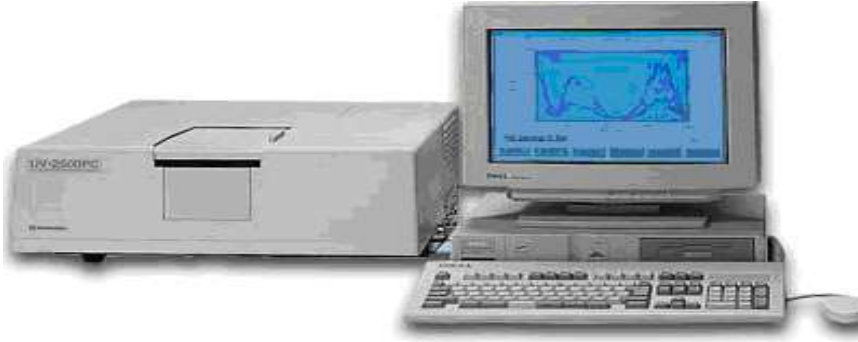
الشكل(105):مخطط وصورة لجهاز مطياف الامتصاص في منطقة الأشعة فوق البنفسجية .
