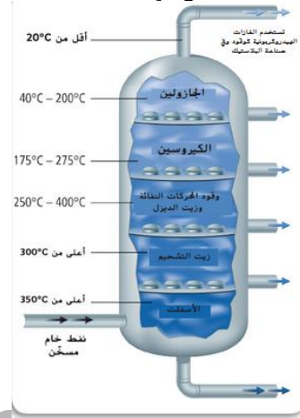
■ الشكل 7 يتم فصل الأجزاء في برج التجزئة حسب درجات غليانها، وتتميز الهيدروكربونات الكبيرة بدرجات غليان مرتفعة وتكثف على اللوحات السفلية، أما الهيدروكربونات الصغيرة فتتميز بدرجة غليان أكثر انخفاضاً وتجمع عند قمة البرج في صورة غازات.
