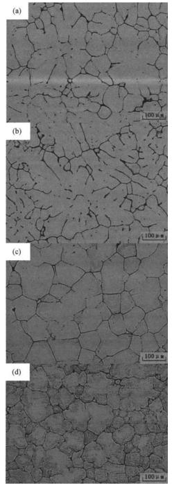
Fig. 1 Microstructure of ingots (a) DC, (b) A-DC, (c) EM\_DC and (d) EMA-DC
