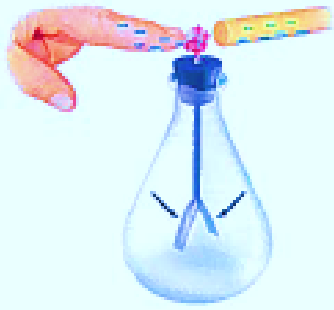
ملاحظة الكشاف الكهربائي تصبح للشحبة المتساوية بدلاً من الإلكترونات الخارج إلى اليد بدلاً من الأسفل إلى الأرضين
