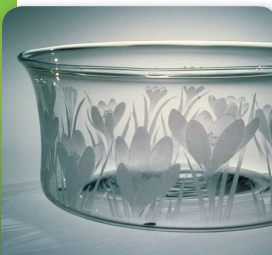
الشكل 6: لو يفس هذا الشكل المتجه أجزاء من هذا الزجاج كيميائياً باستخدام فلوريد الهيدروجين (HF) وهو حمض ضعيف، يتفاعل فلوريد الهيدروجين مع السيليكا، وهو المكون الرئيس للزجاج. ويكوّن رابع فلوريد السيليكون الغازي (SiF 4 ) والماء.
