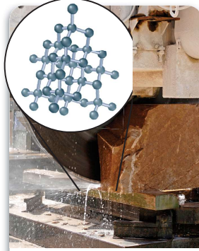
■ صورة 25 عادة ما تستخدم المواد الصلبة الشبكية أدوات للقطع بسبب صلابتها الشديدة. تين الصورة شفرة مشمار مغلقة بالألماس لقطع الحجر.
