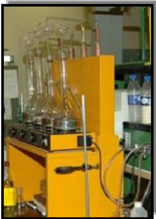
شكل ( ٢-١٤ ) يوضح جهاز سوكلنت وأنابيب جبر اللذان يستخدمان فى تقدير الدهن
