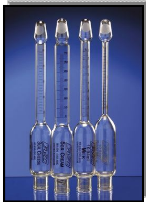
شكل ( ٢-١٤ ) يوضح جهاز سوكلنت وأنابيب جبر اللذان يستخدمان فى تقدير الدهن
