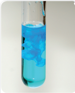
الشكل 14-4 عندما يضاف هيدروكسيد الصوديوم إلى محلول كلوريد النحاس II \text{CuCl}_2 ، تتبادل أيونات \text{OH}^- و \text{Cl}^- مواقعهما، وينتج عن التفاعل كلوريد الصوديوم الذي يبقى في المحلول، وهيدروكسيد النحاس II \text{Cu(OH)}_2 الذي يترسب على شكل مادة صلبة زرقاء اللون.
