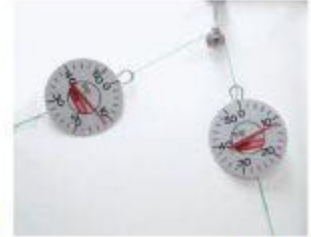
الشكل 4.8 حبل يمر على بكرة متصل بها أجهزة قياس قوة، توضح أن مقدار القوة ثابت في كل أجزاء الحبل.
