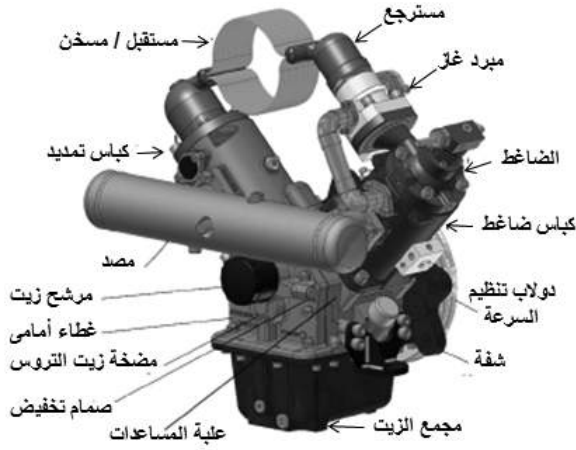
شكل (8) محرك ستيرلينج للمحطة بشكل (6)
