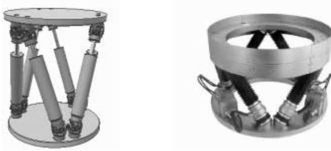
شكل (20) متعقب هليوستات من نوع التوزاي (Source: Orshan, 2010)
