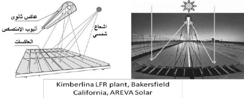
شكل (7) مكونات عاكسات (أو مجمعات) فرسنة الخطية
