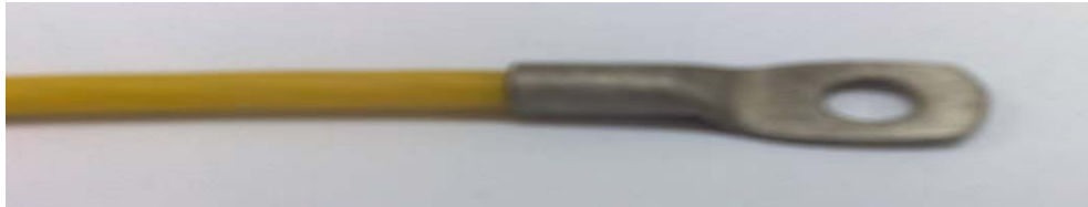
وضع لحام القصدير داخل الجلبة تحت درجة حرارة التشغيل
