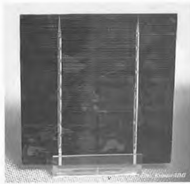
الشكل (2-2): منظر أمامي لخلاية شمسية سيليكونية متعددة البلورة مربعة بمقاس 10 \text{ cm} \times 10 \text{ cm} .
