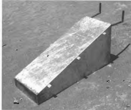
الشكل (10-20): خزان لخفض درجة حرارة الخلية ويخدم كقاعدة/حامل للمنظومة، صنع في مدينة هراري بزمبابوي، من فولاذ مجلفن (من دون دعم للحمل الحراري الداخلي).
