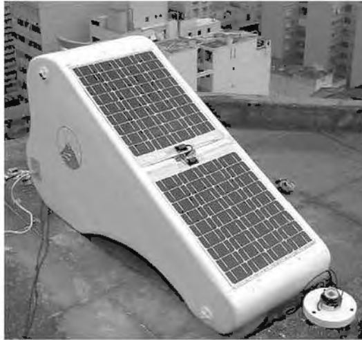
الشكل (10-26): نموذج النظام المنزلي الشمسي المتكامل في أثناء الاختبارات في كوياباكابانا، ريو دي جانييرو. تصميم معتل من "مدرسة الفنون الجميلة" بجامعة UFRJ، ريو دي جانييرو.
