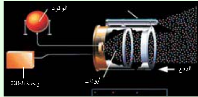
● شكل (٣) نظام دفع كهربائي (Xenon).
