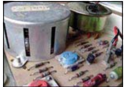
● شكل (٤) الشكل الخارجي لحجرة التآين
