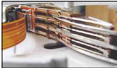
● شكل (٢) قرص صلب متعدد الإسطوانات الفوتوغرافية
