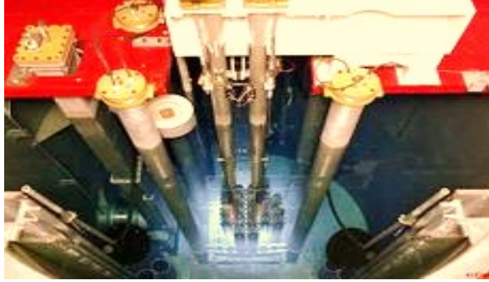
الشكل 120: صورة لإشعاع كيرنكوف (التوهج الأزرق) منبعث من المفاعل النووي TRIGA.
