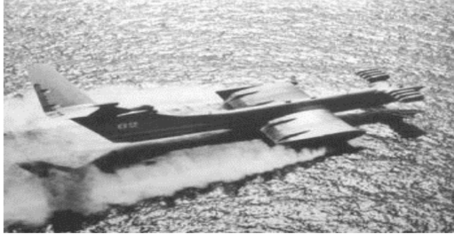
الشكل 4: منظر للطائرة الروسية (الإكرانو) ذات التأثير الأرضي تطير على صفحة الماء.
