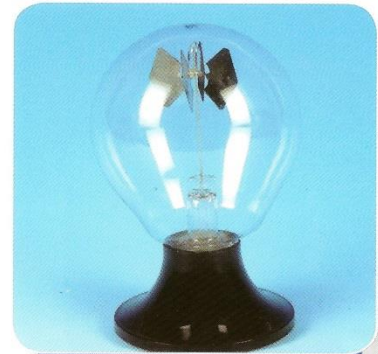
راديوميتر كروكس تعيين الانبعاث الحراري
