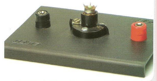
حامل ثبته مع أطرف توصيل في الدوائر الكهربائية
