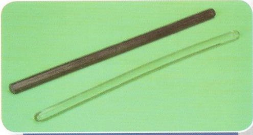
قضيب أبونيت قضيب زجاج للدلك توليد الشحنات بالدلك الكهربية الساكنة /
