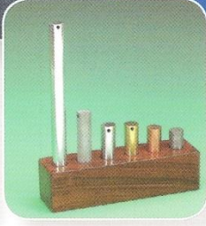
إسطوانات الكثافة. توضيح العلاقة بين الحجم والكتلة والكثافة
