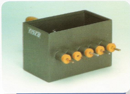
جهاز انجتهاوز توضيح اختلاف توصيل الأجسام الصلبة للحرارة
