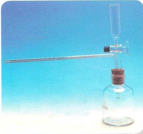
جهاز بوتوميتر لقياس المياه المستخدمة بواسطة النبات خلال عملية البناء الضوئي
