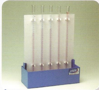
جهاز تمدد السوائل تعيين تمدد السوائل بالحرارة
