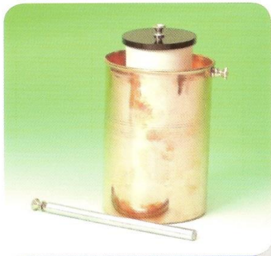
عمود دانيال تحويل الطاقة الكيميائية إلى طاقة كهربائية
