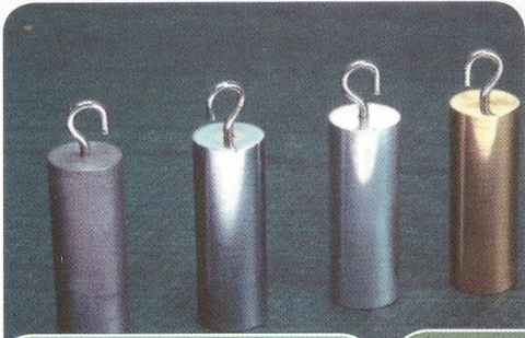
إسطوانات الكثافة. توضيح العلاقة بين الحجم والكتلة والكثافة
