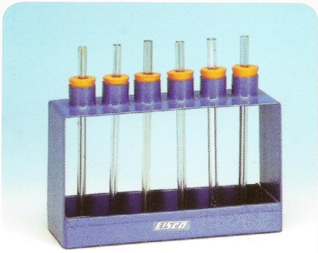
جهاز الخاصية الشعرية. توضيح العلاقة بين ارتفاع السائل في الأنبوب وقطر الأنبوب
