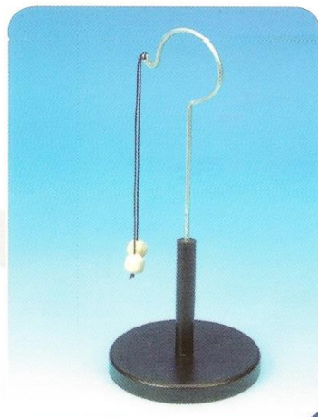
كشاف كهربائي بكرتي بيلسان الكشف عن وجود شحنة كهربائية
