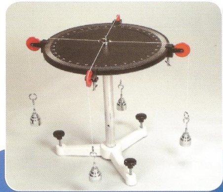
طاولة توازن القوى توضيح كيفية إتران جسم في حالة تساوي قوى الشد الواقعة عليه
