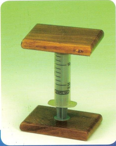
جهاز بويل (بسيط) العلاقة بين قوة الضغط وحجم الغاز المضغوط
