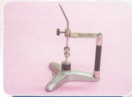
مانعة صواعق توضيح فكرة عمل مانعة الصواعق للمباني
