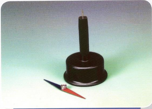
إبرة مغناطيسية على حامل تجارب المغناطيسية و توضيح فكرة عمل البوصلة
