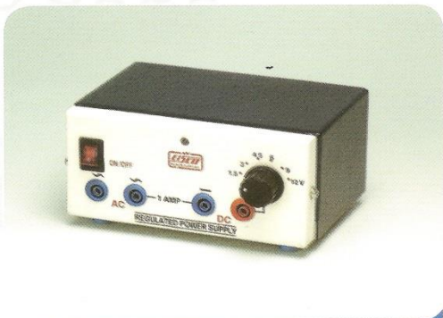
مصدر تغذية (مستمر) متردد) من ١,٥ - ١٢ فولت في الدوائر الكهربائية
