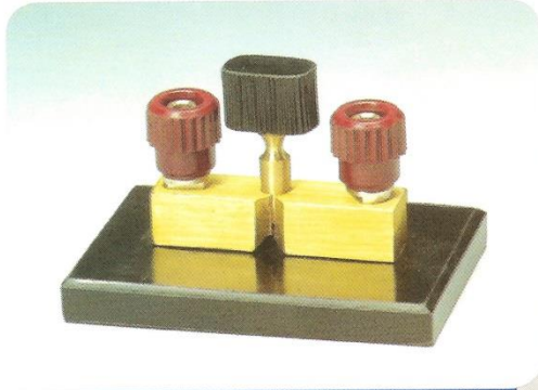
قاطع كهربى في الدوائر الكهربائية
