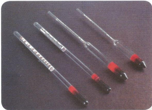
هيدروميتر سوائل خفيفة. قياس كثافة السوائل الخفيفة
