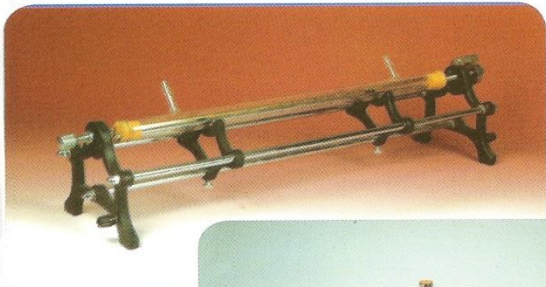
جهاز جنتر تعيين التمدد الطولي لساق معدنية
