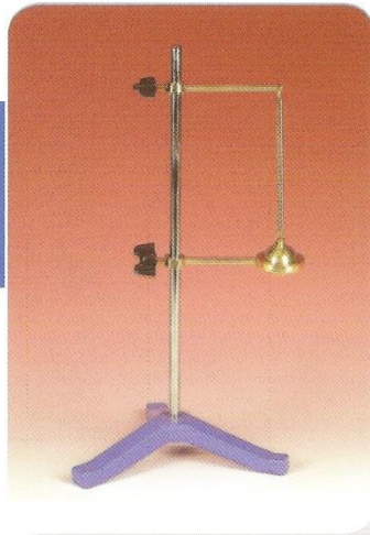
جهاز الكرة و الحلقة على حامل توضيح تمدد المعادن بالحرارة
