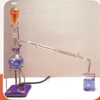
جهاز ت تقطير الماء بسيط للشرح
