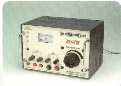
مصدر تغذية (مستمر) متردد) حتى ٣٠ فولت في الدوائر الكهربائية
