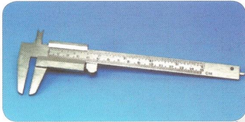
قدمة ذات ورائية. قياس الأقطار للأشكال الدائرية وقياس الأطوال بدقة.
