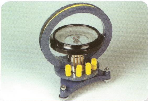
جلفانومتر الخلل قياس شدة التيار الكهربائي
