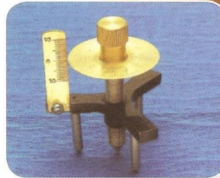
جهاز سفيروميتر قياس التكور
