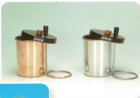
مسعر حراري (نحاس / ألومنيوم) تعيين الحرارة النوعية للمعادن
