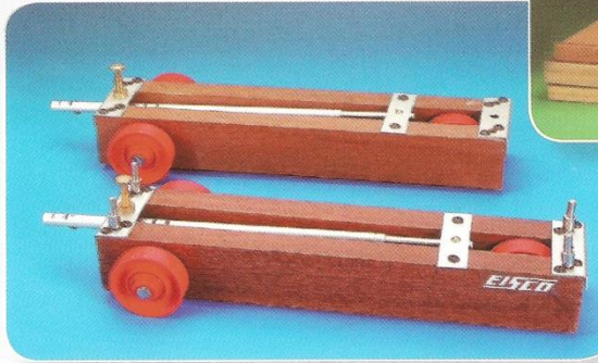
عربة فلتشر مع لوح التصادم تجارب الميكانيكا ( حساب سرعة جسم التصادم المرن / التصادم الغير مرن)
