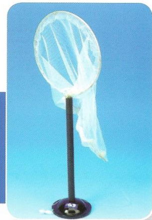
شبكة فاراداي توضيح أن الشحنات الكهربائية تتجمع علي السطح الخارجي للموصل
