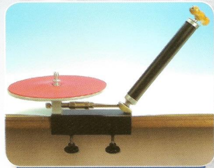
قرص تفريغ هواء مع مضخة يدوية تفريغ الهواء بالباقوس الزجاجي
