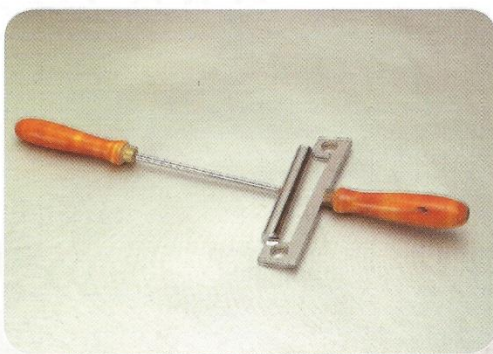
جهاز الساق و القوس توضيح تمدد المعادن بالحرارة
