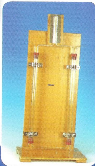
جهاز دوونج وبيتي تعيين معامل التمدد الزئبق
