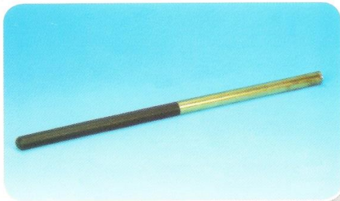
قضيب أبونيت ونحاس للدلك توليد الشحنات بالدلك الكهربية الساكنة /
