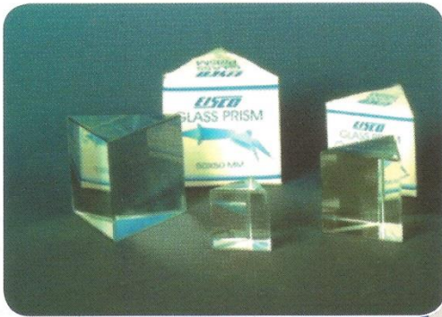
منشور زجاجي قائم الزاوية تعيين معامل الانكسار وزاوية الانحراف / تحليل الضوء
