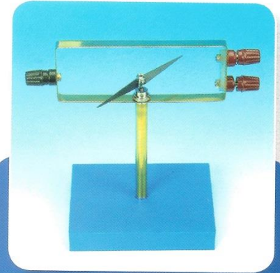
جهاز أورستد توضيح التأثير المغناطيس للتيار الكهربي
