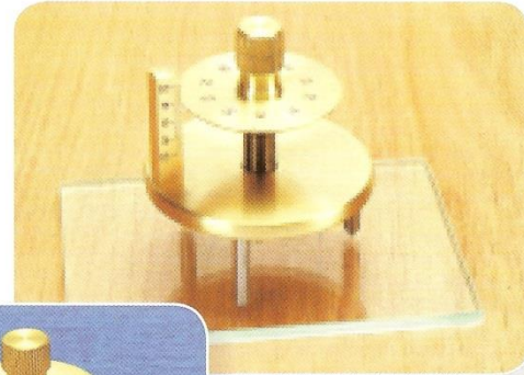
جهاز سفيروميتر قياس التكور
