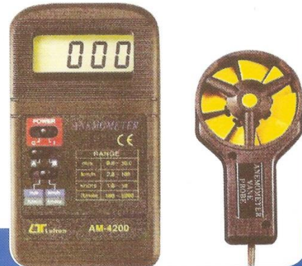
جهاز قياس سرعة الريح قياس سرعة الريح
