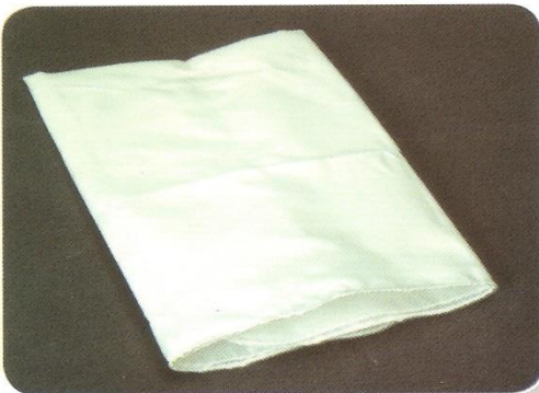
دالك حرير توليد الشحنات بالدلك الكهربية الساكنة /
