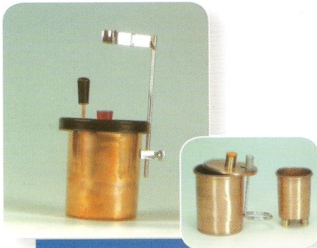
مسعر نحاسي تعيين الحرارة النوعية للمعادن
