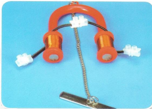
مغناطيس كهربائي توضيح فكرة عمل الرافعة (الوتش) الكهربائية
