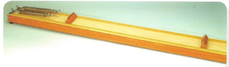
صونومتر للطالب (٢ وتر) توضيح العلاقة بين الرنين الطبيعي لوتر وقوة الشد
