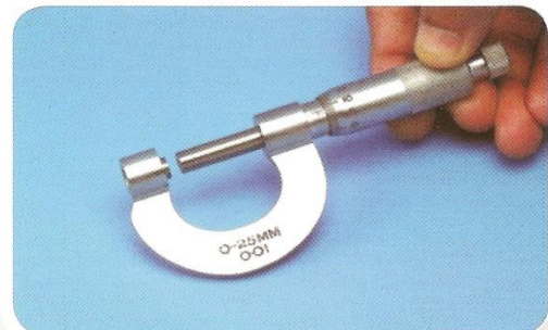
جهاز ميكروميتر. القياسات الدقيقة (سمك المعادن أو قطر سلك).
