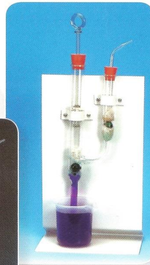
مضخة ماصة كابسة. توضيح كيفية رفع وضخ السوائل
