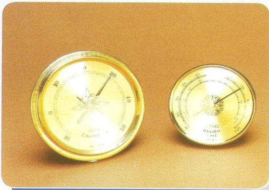
جهاز هيجروميتر قياس الرطوبة في الجو
