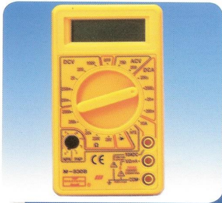
جهاز قياس متعدد قياس التيار و الفولت والمقاومة
