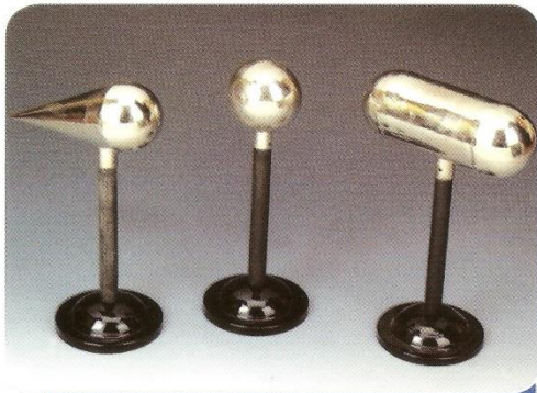
مجموعة موصلات علي شكل كرة و مخروط و إسطوانة دراسة إختلاف توزيع الشحنات علي سطح موصل بإختلاف شكل الموصل
