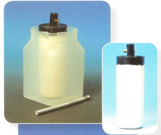
عمود ليكلانش تحويل الطاقة الكيميائية إلى طاقة كهربائية
