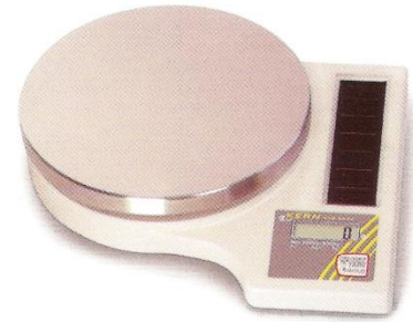
ميزان حساس يعمل بالطاقة الشمسية ولا يحتاج لمصدر تيار.
