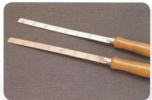
إزدواج حراري توضيح اختلاف تمدد المعادن بالحرارة
