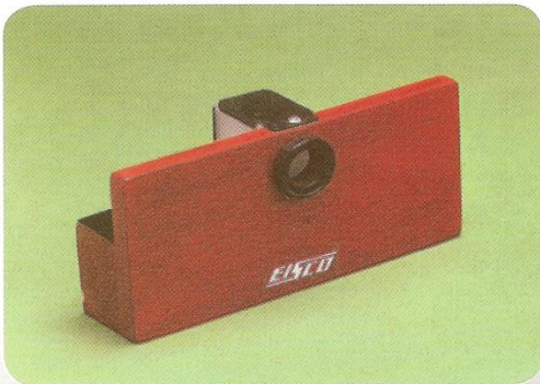
فوتومتر جولي قياس شدة الإضاءة
