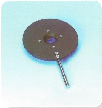
حائل ذو ثقب به علامة + مع المنضدة الضوئية في تجارب الضوء
