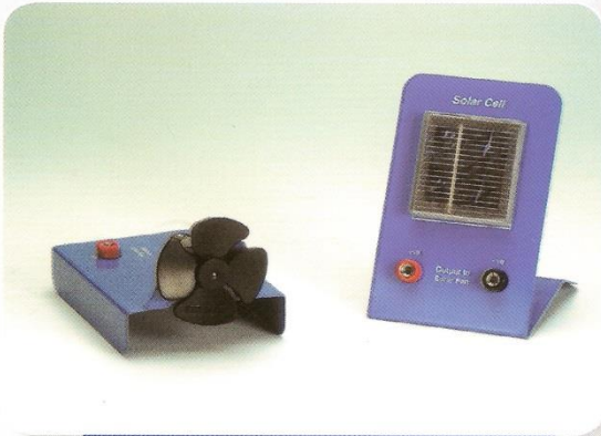
محرك (موتور) يعمل بالطاقة الشمسية تحويل الطاقة الشمسية إلى طاقة حركة
