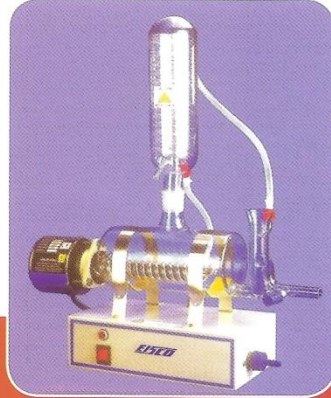
جهاز تقطير الماء زجاجي 2 لتر لكل ساعة
