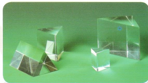
منشور أكريليك متساوي الأضلاع تعيين معامل الانكسار وزاوية الانحراف / تحليل الضوء
