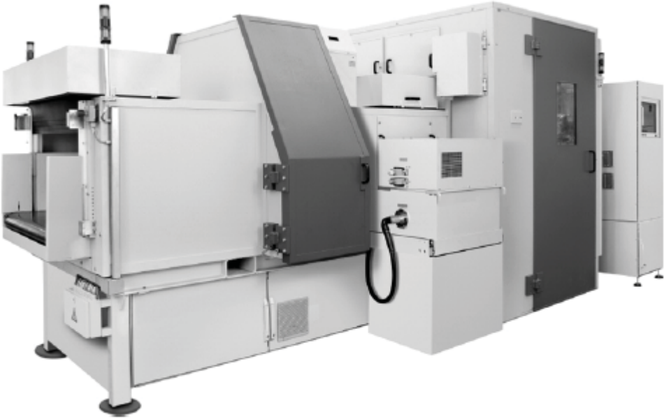
شكل رقم (٥-٦) نظام التصوير المقطعي المباشر بالأشعة السينية الحائدة للبحث عن المتفجرات في حقائب السفر، والأغراض المماثلة [٦].
