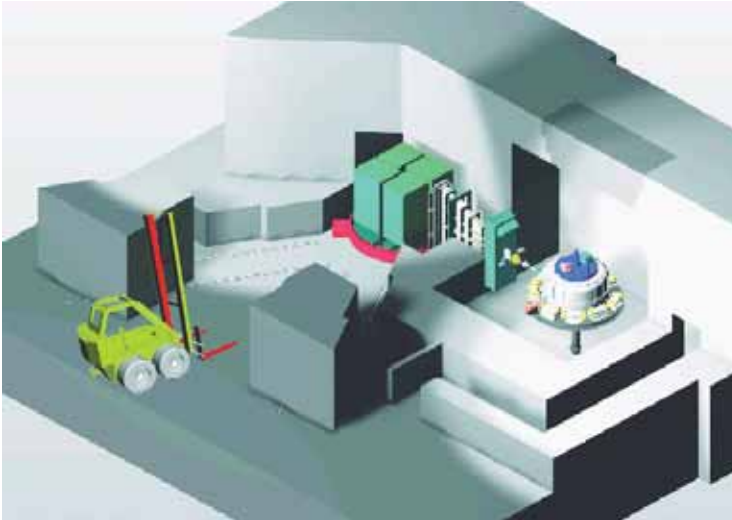
شكل رقم (٣-٢٦) مفهوم جديد لمرفق الأشعة السينية لتعقيم الأجهزة الطبية [١٢٥]
