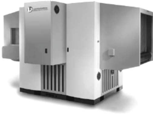
شكل رقم (٦-٣) نظام الفحص MVT يدمج الصور الناتجة من ثلاث مصادر مستقلة للأشعة السينية ليعطي صورة ثلاثية الأبعاد لمحتويات الأمتعة المفحوصة [١].
