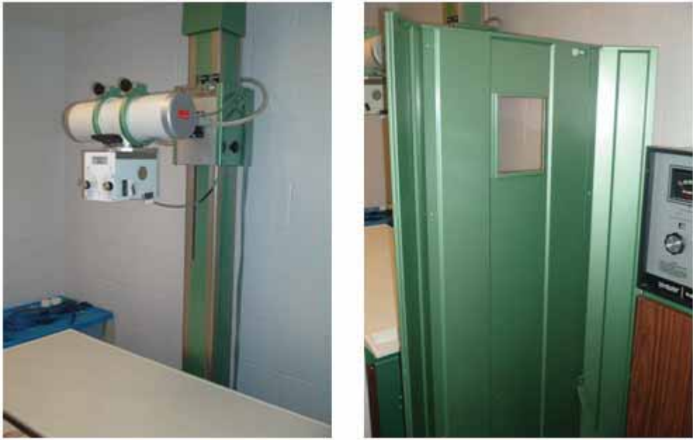
شكل رقم (٩-٢) الحماية المزدوجة للمصادر والعاملين. أنبوب الأشعة السينية محمية (شمال). درع حماية من الرصاص قابل للتحريك (يمين) [٢٤].
