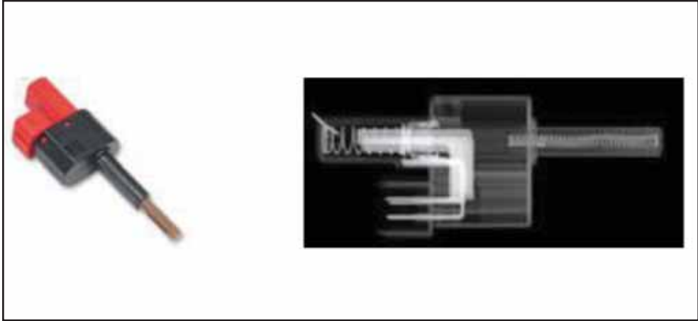
شكل رقم (٦-٣) صورة رقمية بالأشعة السينية لمكونات مفتاح السيارة؛ لاختبار المكونات الداخلية [٩].
