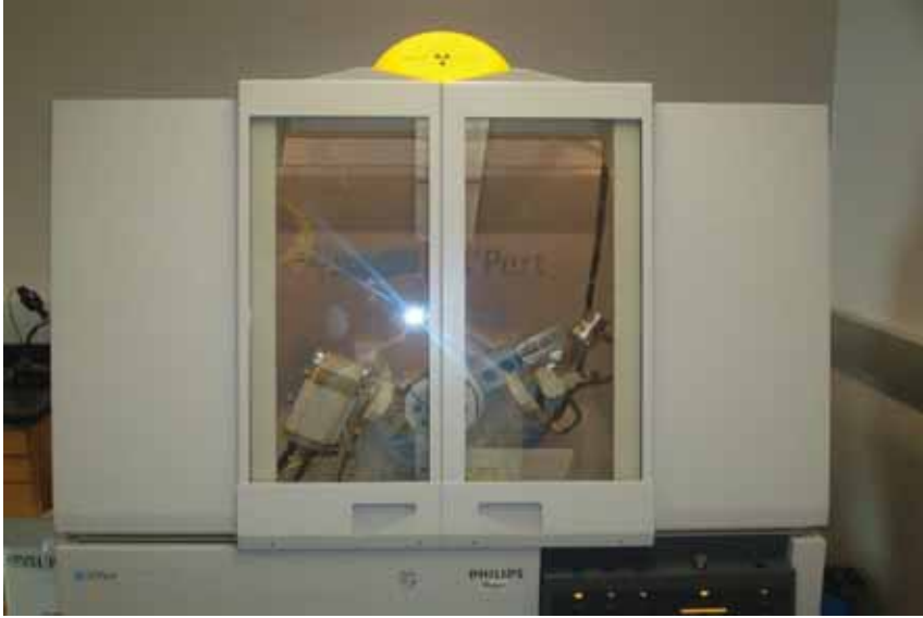
شكل رقم (٩-٣) أنبوب الأشعة السينية والكاشف والعيّنة داخل مقصورة محكمة الغلق
