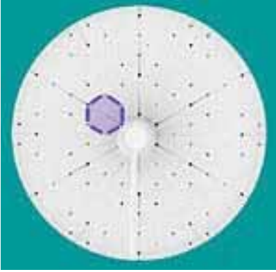
شكل رقم (٤-١٤) نماذج من أنماط حيود الأشعة السينية في بلورات ذات بنية تماثلية مختلفة: مكعبة التماثل (يمين) و سداسية التماثل (شمال) [١١].
