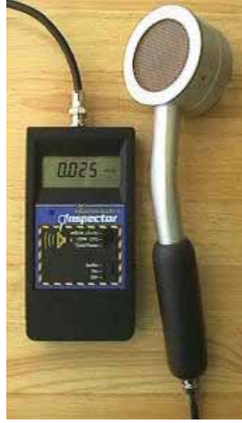
شكل رقم (٧-٧) مواسح إشعاعية رقمية صغيرة الحجم متعددة البرامج لضبط المدى والوحدة [١٠٠].
