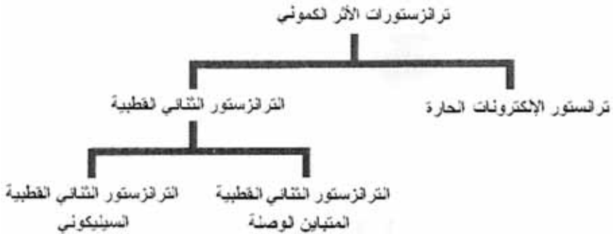
الشكل 30.8: شجرة العائلة لترانزستور الأثر الكموني تنقسم الأدوات في مجموعتين كبيرتين: الترانزستورات ثنائية القطبية وترانزستورات الإلكترونات الحارة
