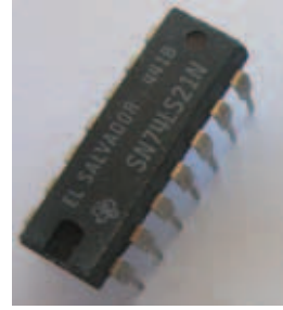
الشكل (٥): رقاقة مصنوعة بتكنولوجيا TTL
