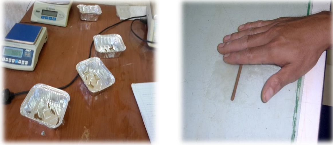
شكل (4-6) يوضح صور معملية لتجربة حد اللدونة
