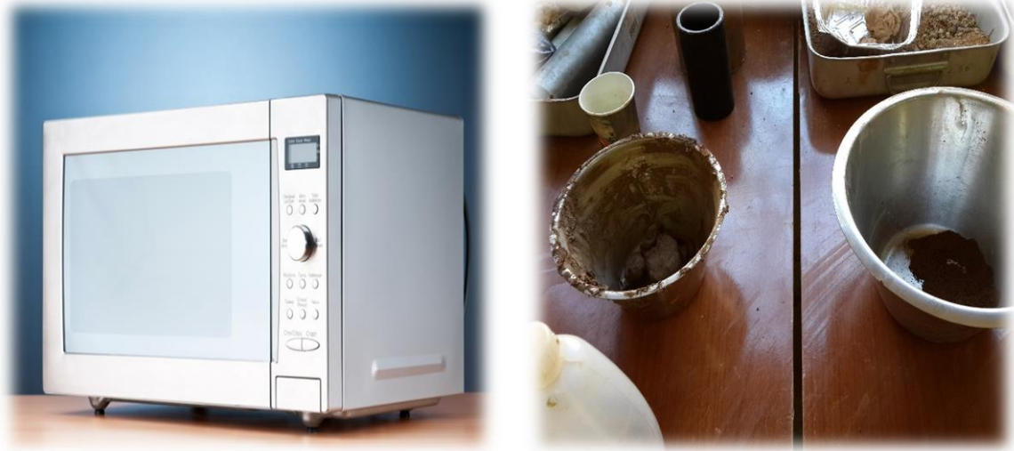
شكل (2-6) يوضح صور معملية لتجربة تعيين المحتوى المائي
