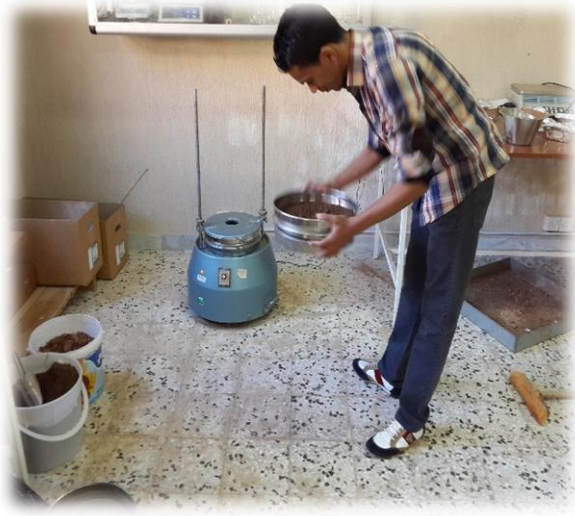
شكل (1-6) يوضح صور معملية لتجربة التدرج الحبيبي
