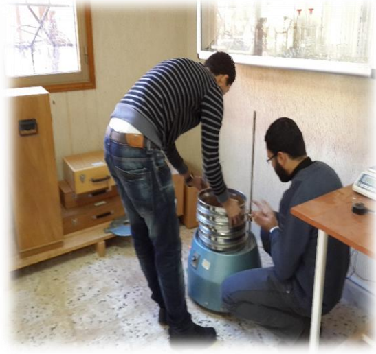
شكل (1-6) يوضح صور معملية لتجربة التدرج الحبيبي
