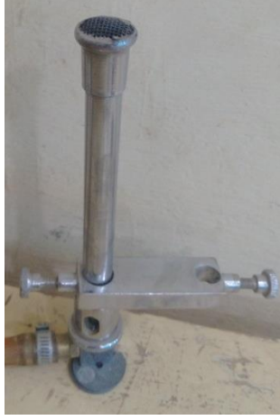
شكل (2.5) المشعل (Burner)
